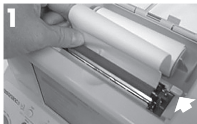
Важіль принтера блокується в положенні друку (вниз)
